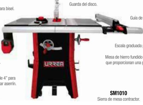
Guarda del disco. Guía de cortes rectos. Escala graduada pulgadas. Mesa de hierro fundido con extensiones de acero que proporcionan una gran superficie de trabajo. Escala para bisel. Paro de emergencia. Ducto de 4" para recolectar aserrín. Ruedas retráctiles para un fácil transporte. **2 1/2 HP 1800 W 110/220 V** EXTRA PESADO monofásico. **SM1010** Sierra de mesa contractor.
